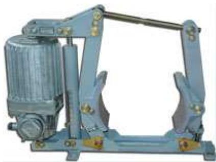
Колодочные тормоза ТКГМ-300 предназначены для удержания валов механизмов (преимущественно подъемно-транспортных машин) в заторможенном состоянии при неработающем электродвигателе, а также для обеспечения плавного и устойчивого торможения крупногабаритных узлов оборудования. Приводятся в действие электрогидравлическим толкателем. Применяются в строительной, горнодобывающей, металлургической и других отраслях промышленности.
